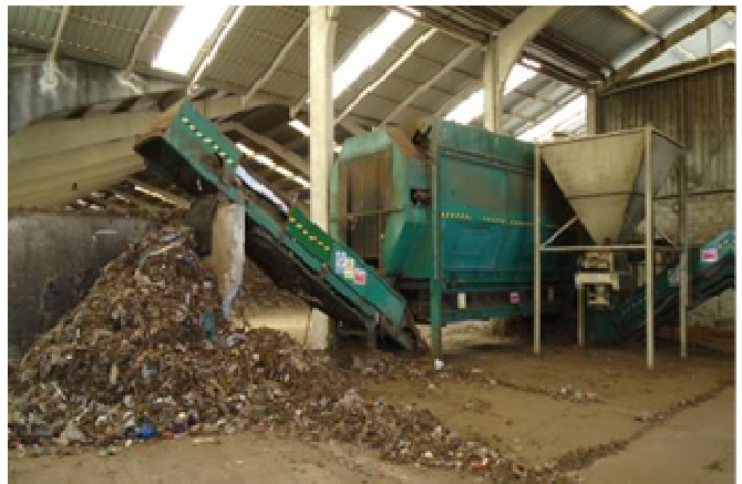
2. Trómel de la planta de afino desechando el rechazo.
